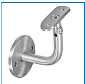
V2A Handlaufträger mit Gelenk mattpoliert, Bohrung 8,5 mm mit Rohranschlussplatte, für Rohr 42,4-48,3 mm Ø Ronde 70,0 x 6,0 mm Schenkel 75,0 x 75,0 mm x Ø 14,0 mm Art.-Nr. 75776
