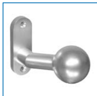
Kugelkopf auf Ovaler Rosette Leichtmetall, feststehend umstellbar von links auf rechts Schraublochabstand 67 mm 8mm Vierkant Art.-Nr. 5507
