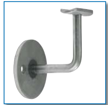
Handlaufträger mit Rohranschlussplatte 64,0 x 24,0 mm für Rohr 42,4 - 48,3 mm Ronde: Ø 70,0 mm Bohrung: 8,5 mm Art.-Nr. 7215
