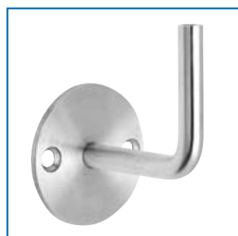
V2A Handlaufträger mattpoliert, Senkkopfbohrung: 8,0 mm, Ø Ronde: 70,0 x 4,0 mm; feingedreht, Schenkel 75,0 x 75,0 x 12,0 mm mit beidseitigem Innengewinde M6
