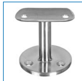
V2A Handlaufträger mattpoliert, Senkkopfbohrung: 3x Ø 5,0 mm, Ø Ronde: 60,0 x 5,0 mm; Höhe: 62 mm Ø 14 mit Gewinde M6 mit Rohranschlussplatte für Rohr Ø 33,7 mm
