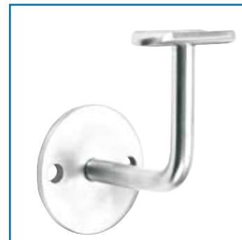
V2A Handlaufträger mattpoliert, Bohrung 8,5 mm mit Rohranschlussplatte, für Rohr 42,4-48,3 mm Ø Ronde 70,0 x 6,0 mm Schenkel 75,0 x 75,0 mm x Ø 12,0 mm Art.-Nr. 75610
