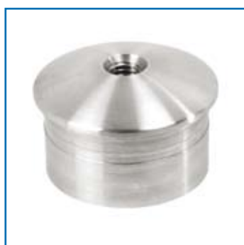
V2A Abschlussstopfen mattpoliert zum Einkleben, Gewinde M8, für Rohr 42,4 × 2,0 mm Art.-Nr. 75875
