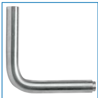
V2A Handlaufträgerwinkel blank, ohne Gewinde Schenkel 75,0 x 75,0 mm x Ø 12,0 mm Art.-Nr. 75670
