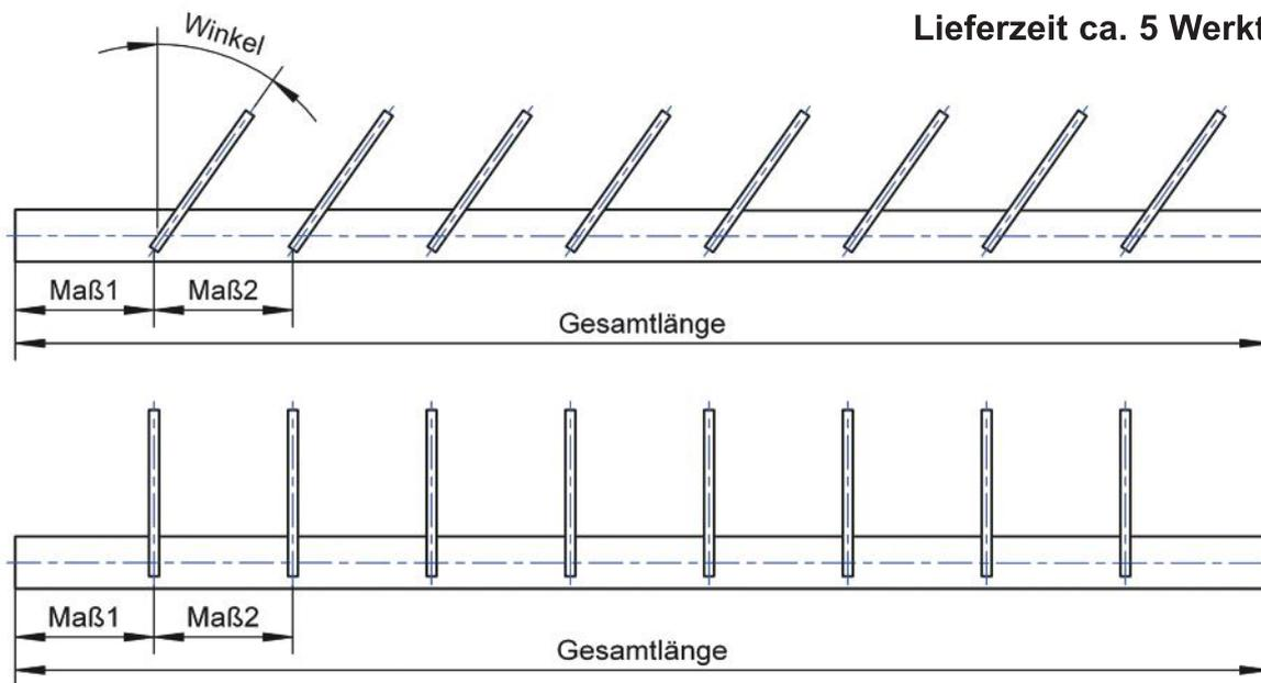
gestrichelte Linie = Bohrachse
