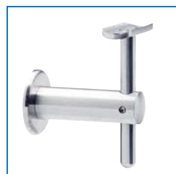
V2A Handlaufträger fein-mattiert Ø 25,0 mm, Ø 12,0 x 100,0 mm und Rohrschlussplatte für Rohr Ø 42,4 - 48,3 mm, Wandabstand mitte Handlauf 75,0 mm Art.-Nr. 75614
