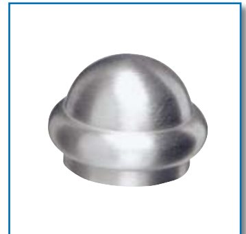
V2A-Zierstück mattpoliert Mat.: Ø 20,0 x 16,0 mm, mit Sackloch Ø 12,3 mm Werkstoff: 1.4305 (AISI 304) Art.-Nr. 7465
