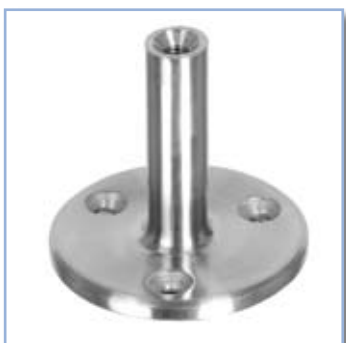
V2A Handlaufträger mattpoliert, Senkkopfbohrung: 3x Ø 5,0 mm, Ø Ronde: 60,0 x 5,0 mm; Höhe: 62 mm Ø 14 mit Gewinde M6
