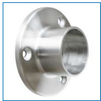
V2A Flanschverbindung Oberfläche 320 Korn geschliffen 3 gesenkte Bohrungen Ø 5 mm Ronde Ø 80 x 5 mm passend für alle Steckverbindungen Ø 42,4 x 2 mm
