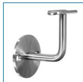
V2A Handlaufträger mattpoliert, Senkkopfbohrung: Ø 8,0 mm, Ø Ronde: 70,0 x 4,0 mm; feingedreht, Schenkel 75,0 x 75,0 x 12,0 mm
