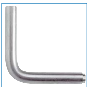
V2A Handlaufträgerwinkel blank, mit 2 Gewinde M6 Schenkel 75,0 x 75,0 mm x Ø 12,0 mm Art.-Nr. 75691
