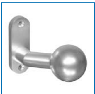
Kugelkopf auf Ovaler Rosette Leichtmetall, Drehbar umstellbar von links auf rechts Schraublochabstand 67 mm 8mm Vierkant Art.-Nr. 5506
