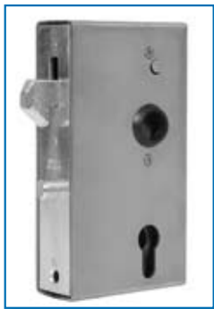
Art.-Nr. 5219 Schiebetor-Schlosskasten mit verzinktem Schloss Kasten: 40 mm / Dorn: 60 mm Höhe: 173 mm / Breite: 94 mm mit Hakenfalle und Dorn
